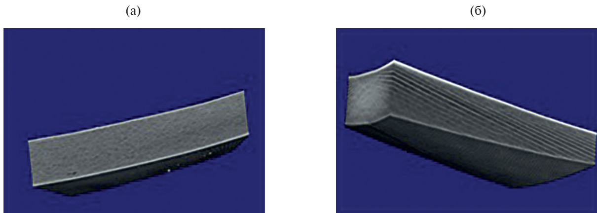
Рис. 1. Микротомография контрольных и опытных образцов: а — биополимерная пленка без фермента; б — биополимерная пленка с ферментом Fig. 1. Micro-CT of control and experimental samples: a — biopolymer film without enzyme; b — biopolymer film with enzyme
